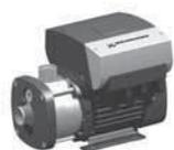
Горизонтальный многоступенчатый моноблочный насос со встроенным преобразователем частоты. Электродвигатель 1 x 220-240 В или 3 x 380-415 В, 50/60 Гц. Материалы проточной части: все детали выполнены из нержавеющей стали EN 1.4401/AISI 316. Торцевое уплотнение вала: карбид кремния/карбид кремния.
